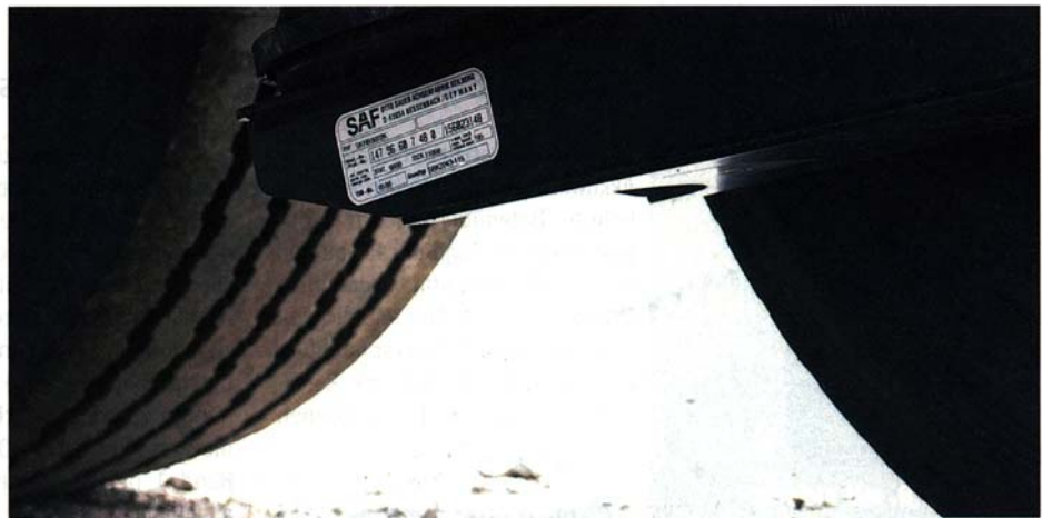
Bild 2: In vielen Bereichen der industriellen Fertigung - wie in der Kfz-Technik - sind Folienschilder Dauerbelastungen jeglicher Art ausgesetzt, beispielsweise durch Verschmutzung oder Abrieb
