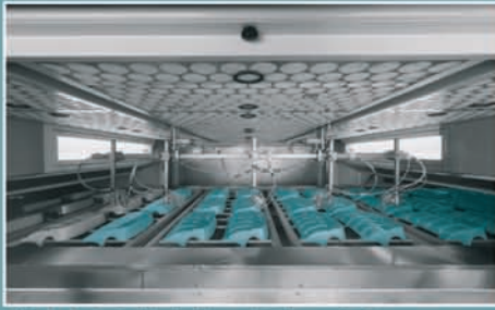
Blick in Spritzlackierkabine mit Palettenfördersystem
