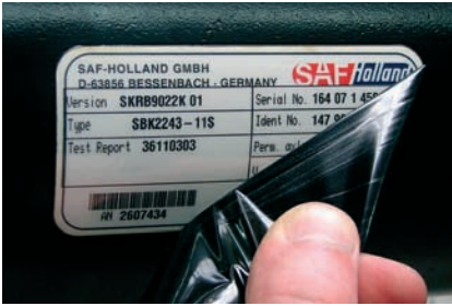
Bild 2. Entfernen des Lackschutzes
